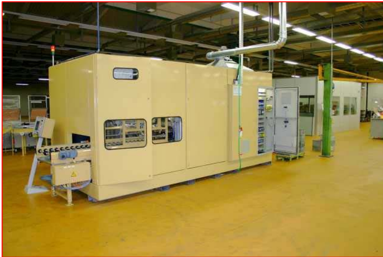
SOLVACS-Durchlaufanlage für die Reinigung und Konservierung von Stanzteilen mit KWL
